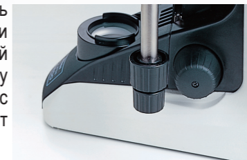
Сравнение положений ручки управления перемещением предметного столика и рукоятки фокусировки
